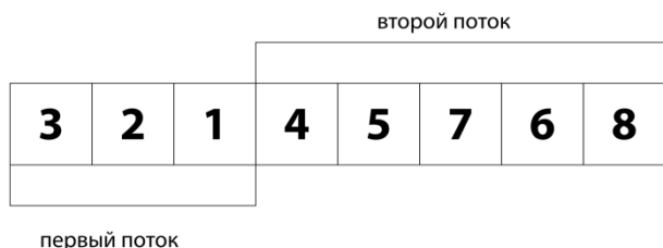
Рис.1. Шаблон распараллеливания методом «Раскидка» для 2-х потоков
