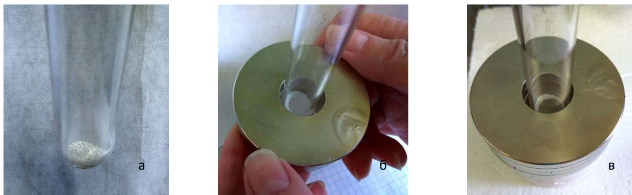
Рис. 2. Образец порошка оксида гадолиния в реакторе без магнитного поля (а) и при внесении его в магнитное поле неодимовых магнитов (б, в)
