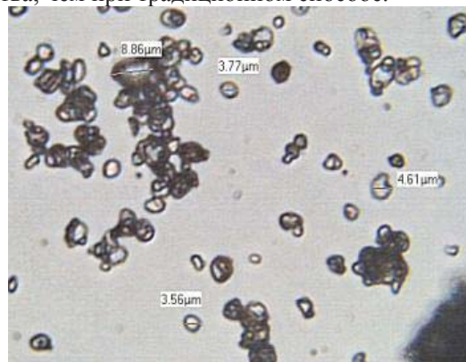
Рис. 1. Фотография смеси МСК/ПХК под микроскопом
