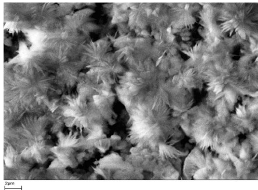
Рис. 5. Электронно-микроскопическая фотография травленого аншлифа образца, обожженного до 1250 °С, видны волокнистые кристаллы витлокита.
